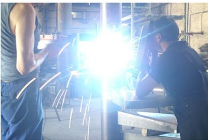
10. Procédez à la soudure permanente de la marche sur le tube central.
