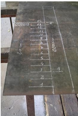
2. Tracez un croquis à l'échelle de l'élévation pour vérifier qu'il ya toujours 220 cm entre les barreaux qui se chevauchent.
