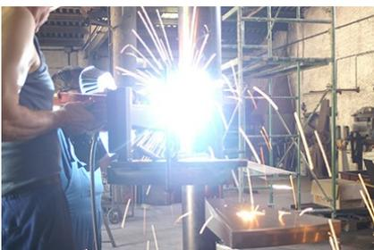
8. La marche est fixée au tube central avec quatre points de soudure.
