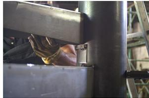
6. Placez la butée de fabrication sur l'outillage et le support arrondi.
