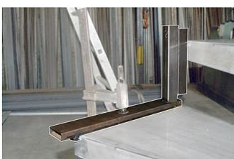
4. Un outil spécial est ancré à l'extérieur de la marche. Cela fait arrêter à l'avant et à côté de la marche et nous dit où mettre le prochain.
